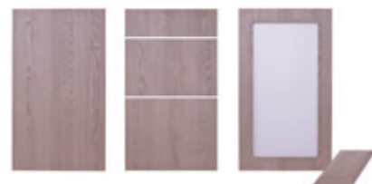
87 Tirano grå eg ▼ ■ 19 mm spånplade med slagfast melamin-belægning med synkron struktur, der følger åreerne. Solid 0,8 mm afrundet ABS kant. Mattered glas i vitrine.
