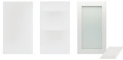
99 Basic hvid ■ 16 mm spånplade med slagfast melamin-belægning. Solid 0,8 mm afrundet ABS kant. Mattered glas i vitrine.
